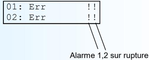
Le message 'Err' indique une rupture du capteur de mesure.
